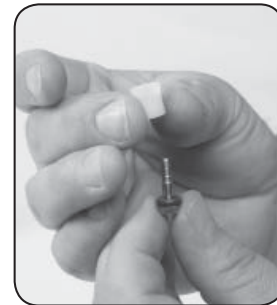
Étape 4. Remplacer le PISTON DOSEUR #44.
