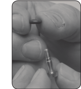
Étape 5. Remplacer le JOINT TORIQUE #14.
