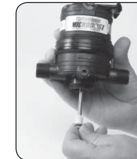
Étape 8. Réinstallez la TIGE DE COMMANDE #52, le JOINT TORIQUE #14 et le PISTON DOSEUR #44.
