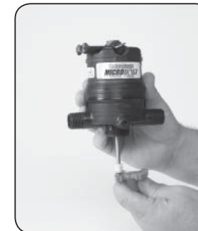
Étape 2. Dévisser la TIGE DE COMMANDE #52 en utilisant la clé Dosmatic 6-1 (fournie).
