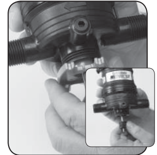
Étape 6 Retirer l'ENTRETOISE #88 en utilisant la clé Dosmatic 6-1.
