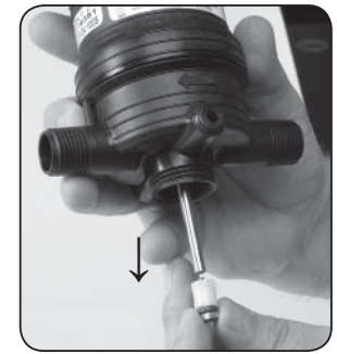
Étape 3. Enlever la TIGE DE COMMANDE #52, le JOINT TORIQUE #14 et le PISTON DOSEUR #44.
