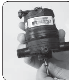
Étape 7. Remplacer le JOINT TORIQUE #17 et réinsérez bien l'ENTRETOISE #88.
